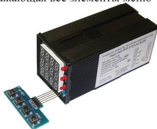
Рис. 11 – P44 с подключенной панелью программирования
