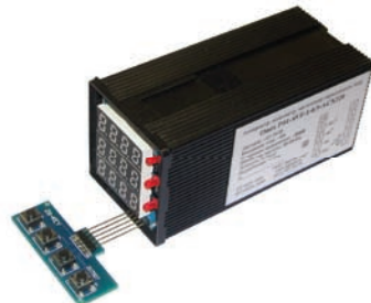
Рис. 9 – P44 с подключенной панелью программирования
