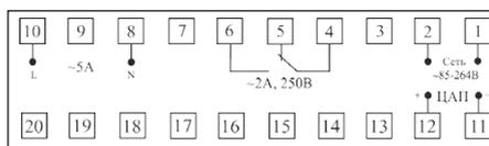
Рис. 9 – Клеммник модели
