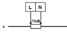
Рис. 6 – Подключение через шунт
