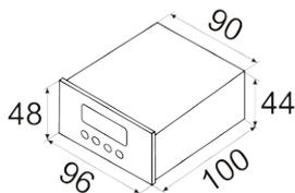
Рис. 2 – Размеры прибора
