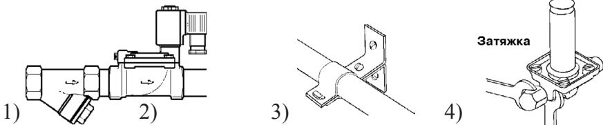
1) Перед монтажом клапана трубопроводы должны быть прочищены, т. к. попадание в клапан инородных частиц может привести к выходу его из строя. Перед входным отверстием соленоидного клапана необходимо установить фильтр-грязевик.
